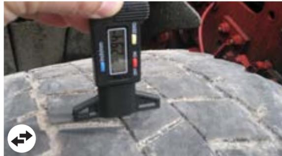
Kratzer, Risse oder Kerben sind tiefer als 3 mm und mehr als 25 mm lang
