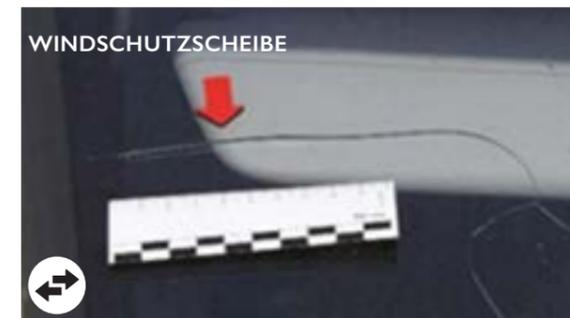
Steinschläge  $> 20$  mm,  $> 3$  Steinschläge oder Steinschläge im Sichtfeld, gerissen, schlecht eingebaut mit Defekt, mit Sandstrahlspuren oder Kratzern
