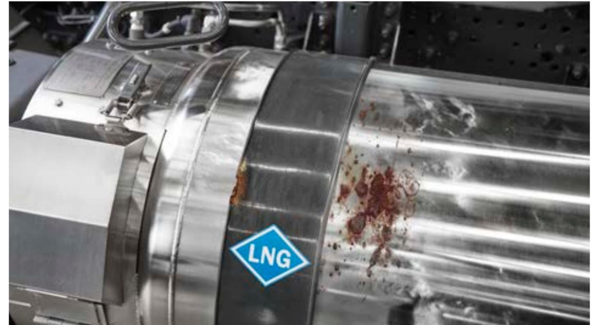
Rost, Dellen, Bruchschäden und/oder Riefen → Berechnung des Austauschs von Halterungen und Haltebändern.
