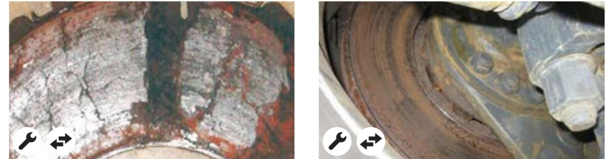
Verrostete, nachgeschliffene, abgenutzte Brems Scheiben
