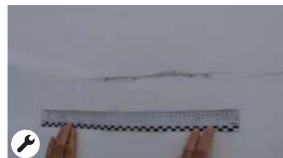
Seitenwände: Kratzer mit Materialabtrag  $\geq 20$ cm, kann auf wirtschaftliche Weise repariert werden. Möglichkeit der Lackierung der Halbverkleidung
