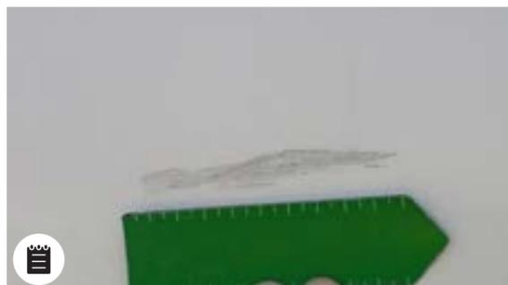
Seitenwände: Leichte Kratzer mit Materialabtrag  $\leq 20$  cm
