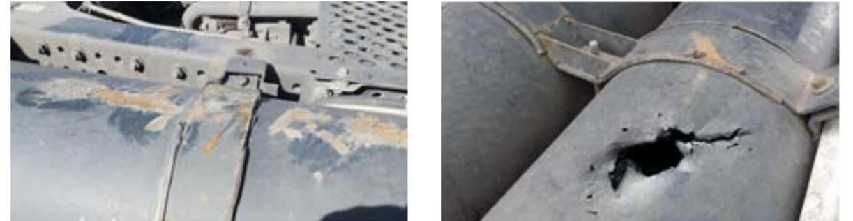
Offensichtliche Reparaturen an der CNG-Flasche → Berechnung des Austauschs der CNG-Flasche.
