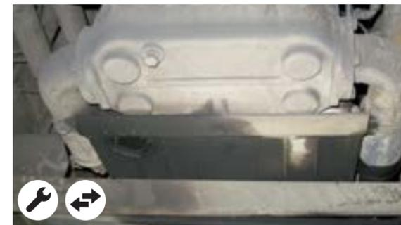
Undichtigkeiten am Lenkgetriebe und an der Servopumpe
