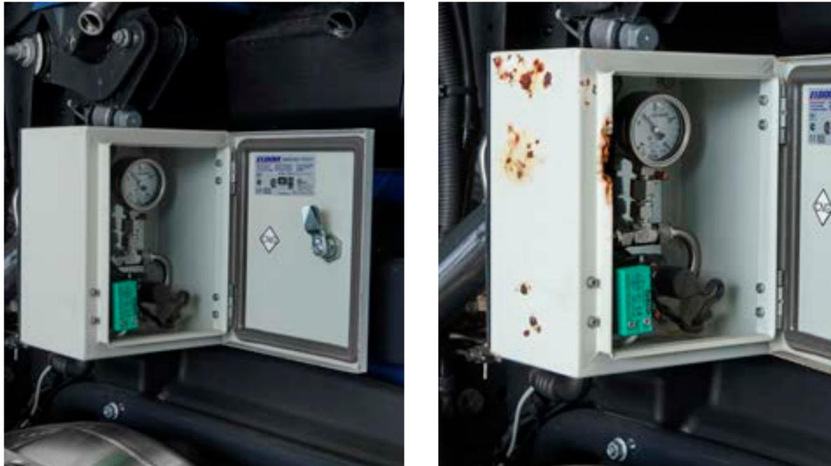
Rost auf Einfüllstutzen-Schutzkasten → Vermerk über den Schaden, ohne Berechnung.
