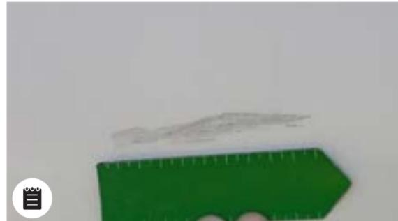
Seitenwände: Leichte Kratzer mit Materialabtrag  $\leq$  10 cm
