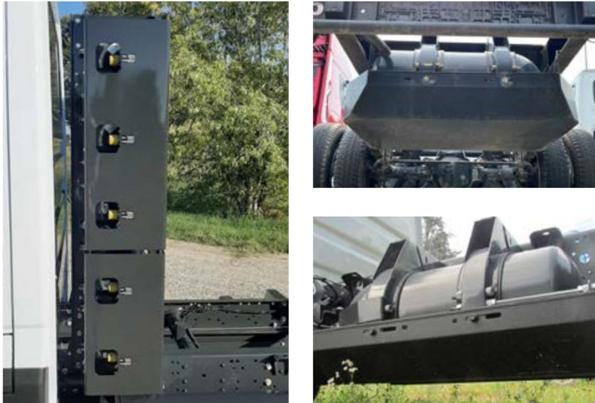
Schutzabdeckungen für CNG-Zylinder müssen in ordnungsgemäßem Zustand zurückgegeben werden, wie in den Bildern dargestellt.
