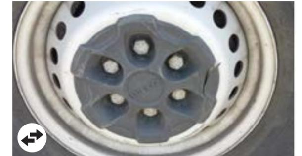
Radabdeckungen: Verformt, gebrochen, Material fehlt oder entfernt
