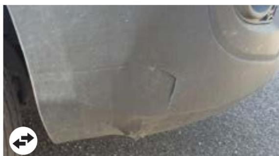
Gebrochene, verformte oder materialabgetragene Bauteile, die nicht durch eine wirtschaftliche Reparatur instandgesetzt werden können.
