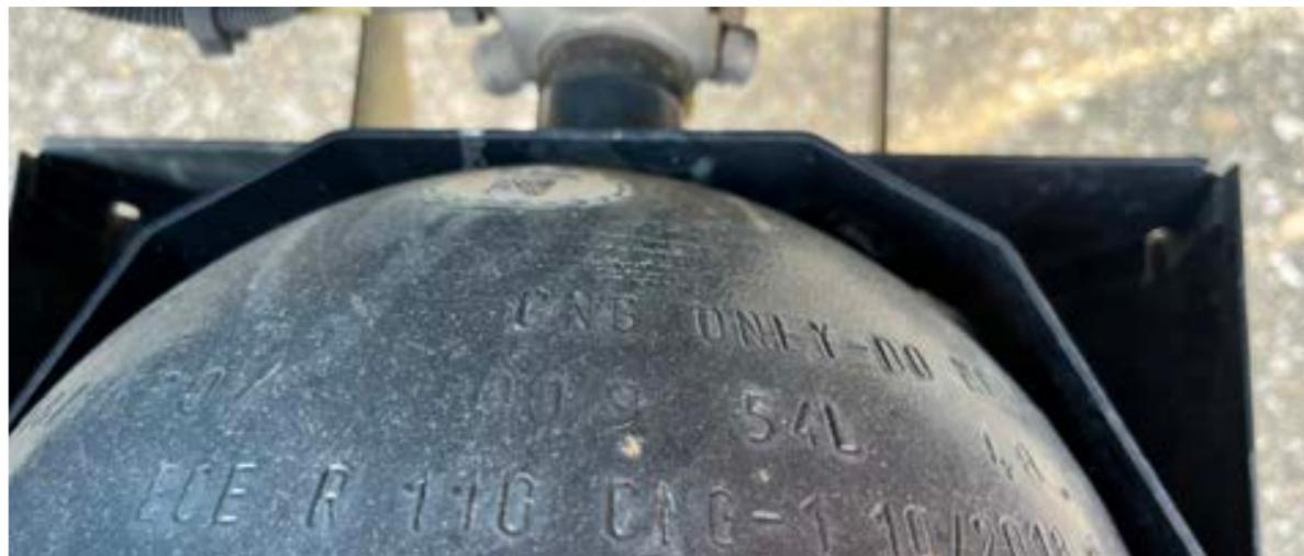
Vorhandensein eines lesbaren aktuellen Gültigkeitszertifikats für CNG-Zylinder.
