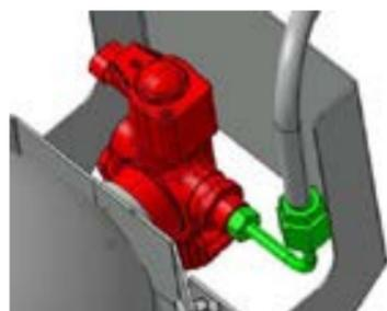
Hochdruckschlauchanschluss zum Rückschlagventil
