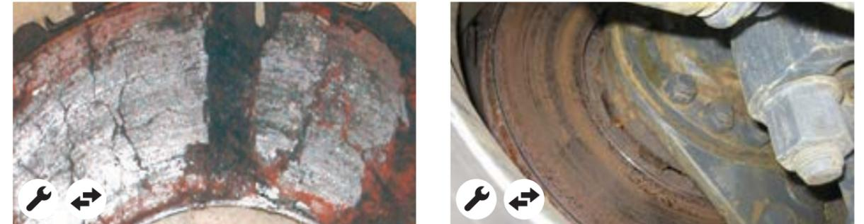
Verrostete, nachgeschliffene, abgenutzte Bremscheiben
