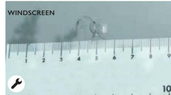
Steinschläge  $\leq 20$  mm, außerhalb des Sichtfeldes und  $\leq 3$  Steinschläge
