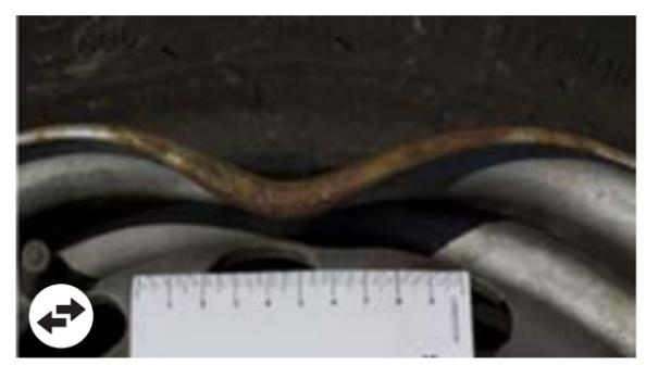
Felgenhorn beschädigt, Felge nicht eingetragen. Durchführung einer Maßprüfung zur Überprüfung des sicheren Zustandes des Fahrzeugs
