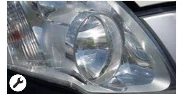
Leichte Kratzer (ohne Materialabtrag), außerhalb des Ausleuchtungsfeldes und des Glühlampengehäuses (POLIEREN)
