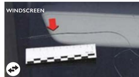
Steinschläge  $> 10$  mm,  $> 3$  Steinschläge oder Steinschläge im Sichtfeld, gerissen, schlecht eingebaut mit Defekt, mit Sandstrahlspuren oder Kratzern durch defekte Scheibenwischer.
