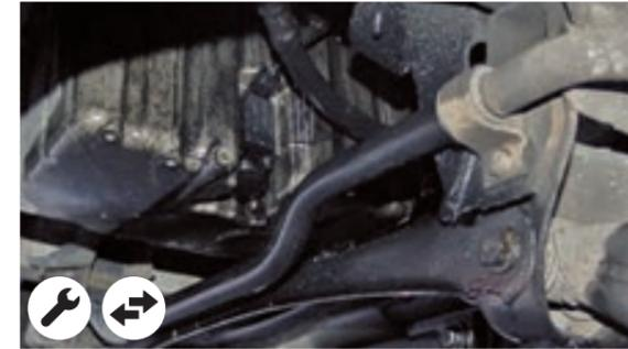
Alle Undichtigkeiten am Motor, Getriebe und Differential, an der hydraulischen Aufhängung und an den Stoßdämpfern
