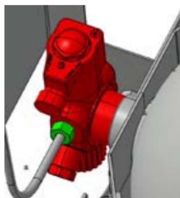
Anschluss aus Edelstahl - starre Verrohrung zum Magnetventil
