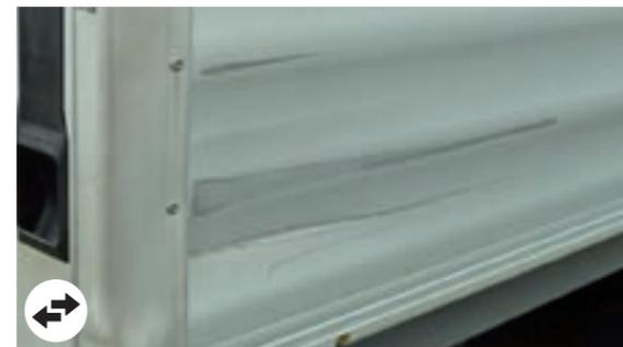
Verformungen in der Schiene wenn  $\geq$  10 cm, Reparatur nicht möglich oder nicht dicht
