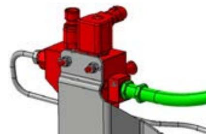
Mitteldruck-Schlauchanschluss zum Druckminderer
