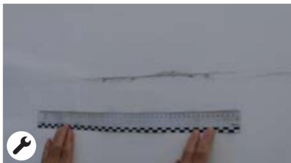
Seitenwände: Kratzer mit Materialabtrag  $\geq 10$  cm, kann auf wirtschaftliche Weise repariert werden. Möglichkeit der Lackierung der Halbverkleidung
