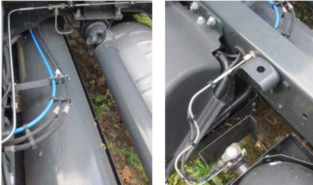
Überprüfen Sie die Unversehrtheit der Benzinleitungen (keine Verluste, keine Anzeichen von tiefen Kratzern). Kraftstoffleitungen müssen in ordnungsgemäßem Zustand zurückgegeben werden, wie in der Abbildung dargestellt.
