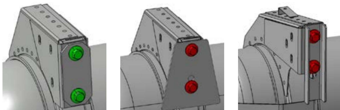
Befestigung der Tankträger am Fahrgestell und des hinteren Querträgers mit Versteifungsplatten
