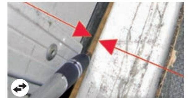
Verformungen in der Schiene wenn  $\geq$  10 cm, Reparatur nicht möglich oder nicht dicht
