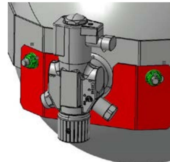
Befestigung der Feuerschutzhalterung.
