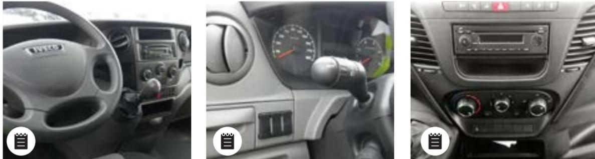
Verschleißerscheinungen an der Instrumententafel, Kombiinstrument und Lenkrad
