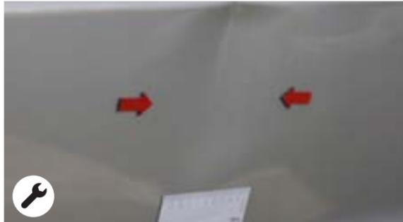
Dellen > 20 mm Durchmesser, Farbunterschiede, Hagelschäden oder größere Dellen
