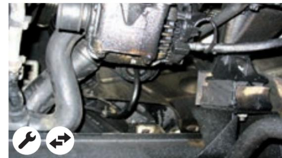
Undichtigkeiten am Lenkgetriebe und an der Servopumpe
