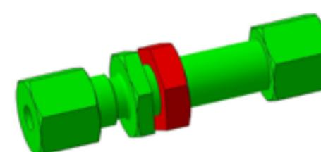
Befestigung durch Kupplung zum Fahrgestell
