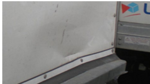
🔧 Seitliche und hintere Türen: Erhebliche Verformung: Reparaturzeit >1 h, kann auf wirtschaftliche Weise repariert werden, Verschluss nicht versiegelt
