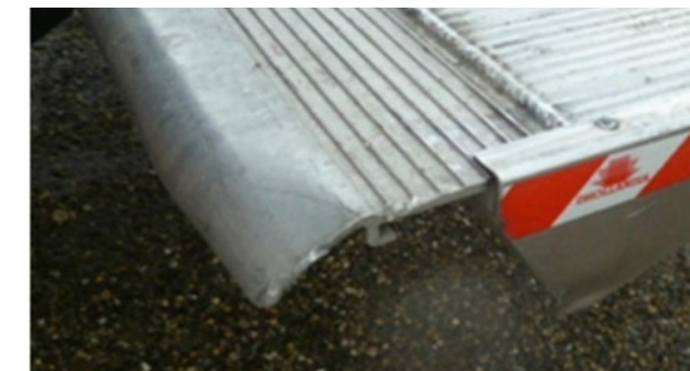
Ladebordwand: Deformationen der Plattform, die auf wirtschaftliche Weise repariert werden können
