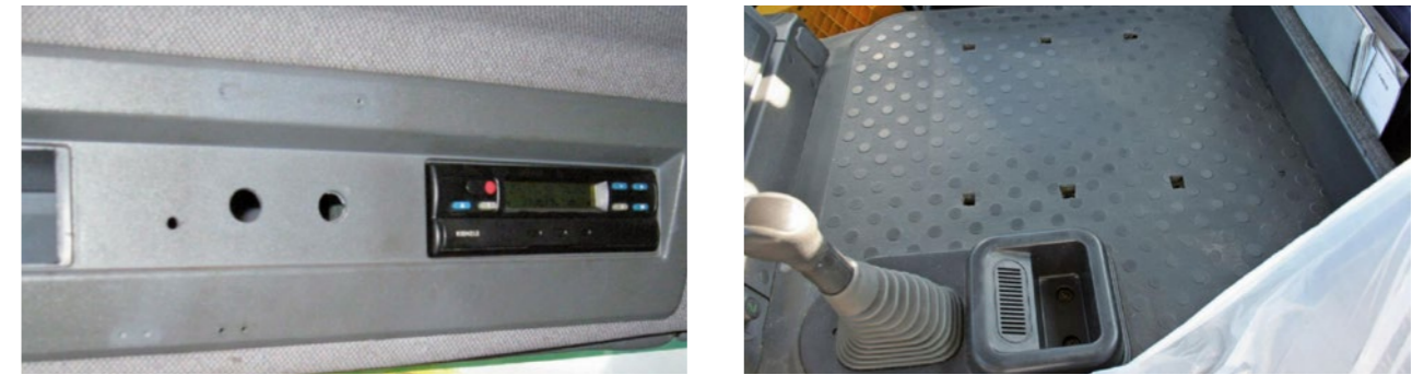
Bedienelemente-, Sitz- oder Verkleidungsteile fehlen, sind gebrochen oder durchbohrt
