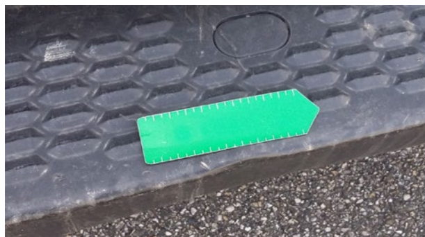
Hintere Trittbretter: Leichte Verformung
