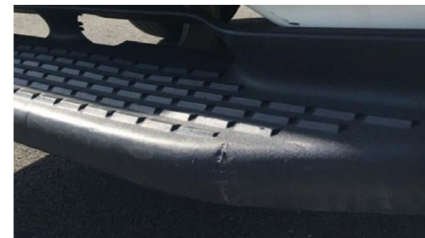
Hintere Trittbretter: Verformungen, die auf wirtschaftliche Weise repariert werden können
