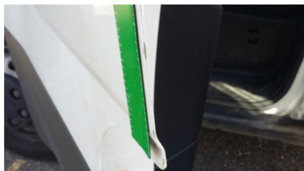
Lackschaden an Türkante
