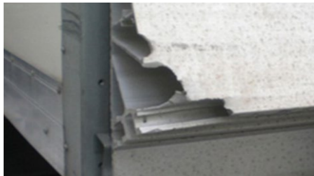
↻ Ladebordwand: Deformationen der Plattform, die nicht auf wirtschaftliche Weise repariert werden können, gebrochene oder unvollständige Verkleidungen
