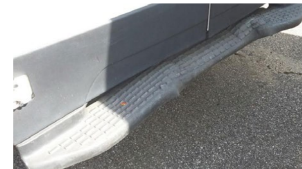
Hintere Trittbretter: Verformungen, die nicht auf wirtschaftliche Weise repariert werden können
